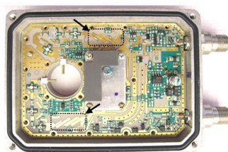
ภาพที่ 1 ตัวอย่างวงจรกรองความถี่แถบผ่านบนโครงสร้างระนาบ (ตามลูกศรชี้) ที่อยู่ในอุปกรณ์แปลงความถี่ลงชนิดสัญญาณรบกวนต่ำ (LNB, Low noise block down-converter)
