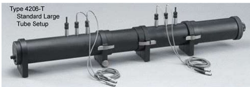
ภาพที่ 6 เครื่องทดสอบการดูดซับเสียง Standard Large Type System รุ่น Type4206 - T
