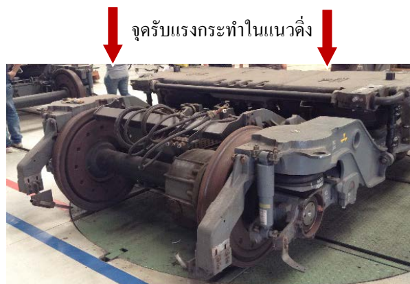
รูปที่ 4 ตำแหน่งแรงกระทำต่อโบกี้รถไฟชานเมือง [7]
