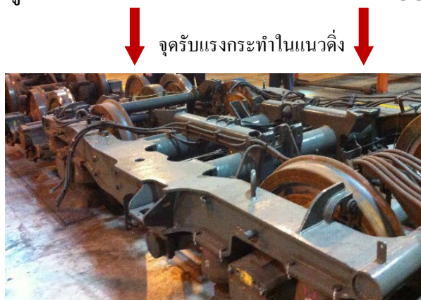
รูปที่ 5 ตำแหน่งแรงกระทำต่อโบกี้รถไฟในเมือง [8]
