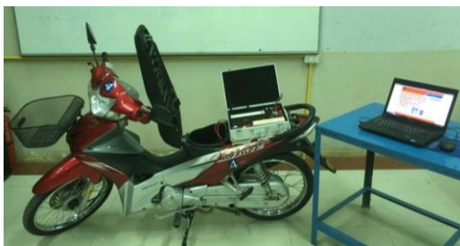
ภาพที่ 1 ชุดสาธิตจำลองการฝึกทักษะการต่อวงจรไฟฟ้ารถจักรยานยนต์
